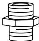
Переходник с внешней резьбой 1¼" для монтажа задвижки сразу после обратного клапана на напорном трубопроводе.
